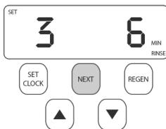
**Шаг 6S** – Введите режим заполнения солевого бака в килограммах или минутах (в нашем примере – FILL) при помощи кнопок «ВНИЗ» или «ВВЕРХ». Когда 2.0 и 2.0L – параметры на Шаге 2CS, и выбран параметр 2.0, или на Шаге 12CS выбран вариант «MIN», заполнение солевого бака в минутах. Клапан управления WS2 поставляются с завода с ограничителем потока реагентной линии 2.2 gpm (8.3 л/мин). Нажмите кнопку «NEXT» для перехода к Шагу 7S. Нажмите кнопку «REGEN», чтобы вернуться к предыдущему шагу.
