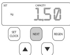
**Шаг 8S** – Установите параметр Ресурс воды в м<sup>3</sup> (Volume Capacity), используя кнопки «ВНИЗ» или «ВВЕРХ». Этот параметр определяет способ выхода системы на регенерацию и может быть настроен следующим образом:
