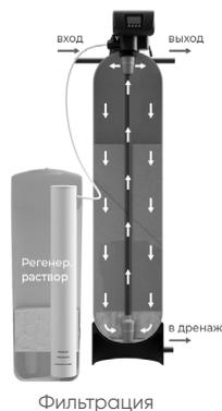
По мере фильтрования воды через слой фильтрующего материала в фильтре все большая часть активных ионообменных групп будет замещаться ионами загрязняющих веществ из воды. В итоге обменная емкость материала будет полностью исчерпана. Для восстановления обменной емкости, требуется регенерация катионита раствором поваренной соли.
