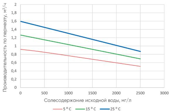
Расчетный график зависимости производительности обратного осмоса от общего соленосодержания при заданных температурах
