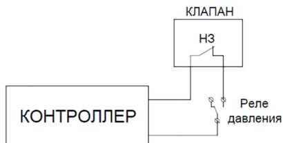
Рис.2 Схема подключения клапана в разрыв сухого хода
