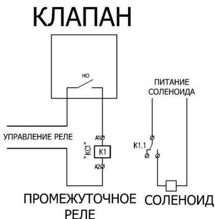
Рис.4 Схема подключения при подаче воды на СОО
